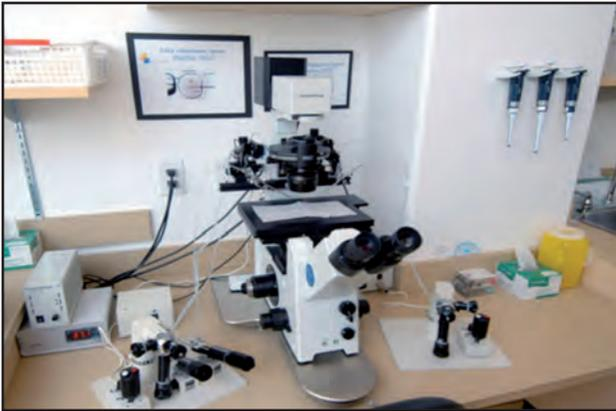
**Figura 40.3-27.** Puesto de microinyección.
