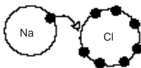
Fig. 1-2. Esquema de la unión iónica o electrovalente. Sólo se muestra la capa externa de electrones.
