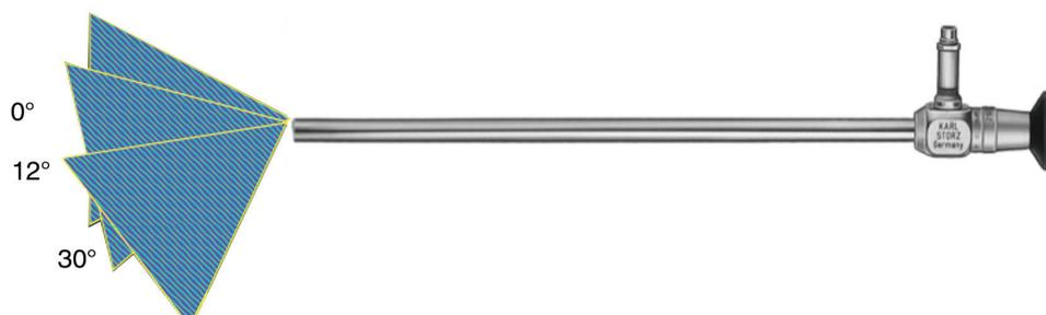
Fig. 1-1. Endoscopio con diferentes ángulos de visión.
